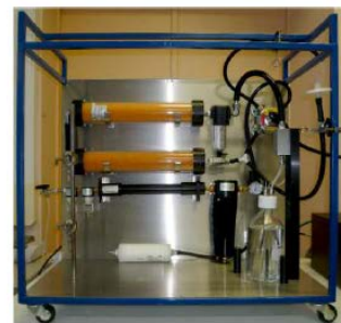
Figure 1 : (A) - Schéma du système portable de génération d'aérosol composé : (1) d'un système d'air comprimé filtré et séché, (2) d'un générateur du type « Constant Output Atomizer » (TSI), (3) de deux sécheurs par diffusion (TSI), (B) - Photo du système portable de génération.
