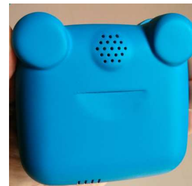
AirBeam (Capteur de particules: Shinyei PPD60PV): Paramètres mesurés : PM2,5/T/HR ...
