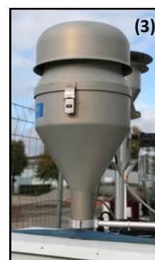
Figure 10 : Collecteur de dépôts totaux pour la mesure de HAP (1) - Préleveur HVS DA80 (2) et sa tête de prélèvement (3)
