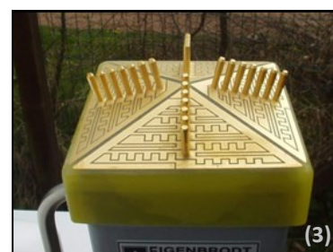
Figure 4 : Vue globale (1) et intérieure (2) du collecteur de précipitations Eigenbrodt NSA181/KHS - Détecteur de pluie RS85 (3)
