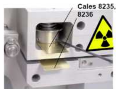
Remontage à l'aide de cales
