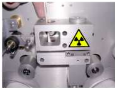
Nettoyage des traverses
