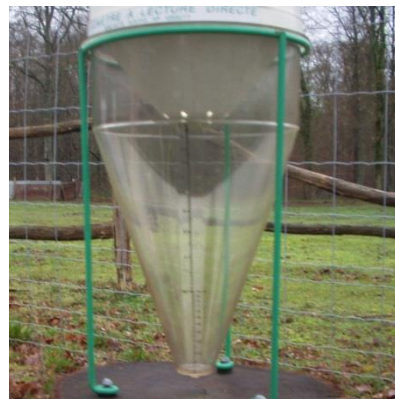
Pluviomètre à lecture directe
