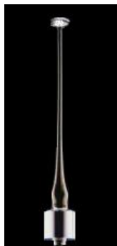
Figure 6 : Elément oscillant surmonté du filtre de collection
