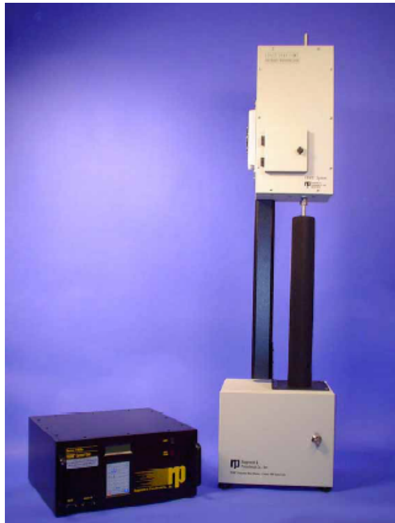
Module FDMS installé sur un TEOM 1400 AB
