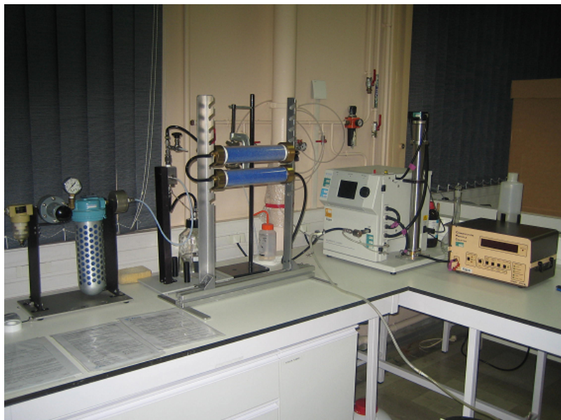
Système de génération de l'aérosol (ASS – COA – SMPS – CPC)
