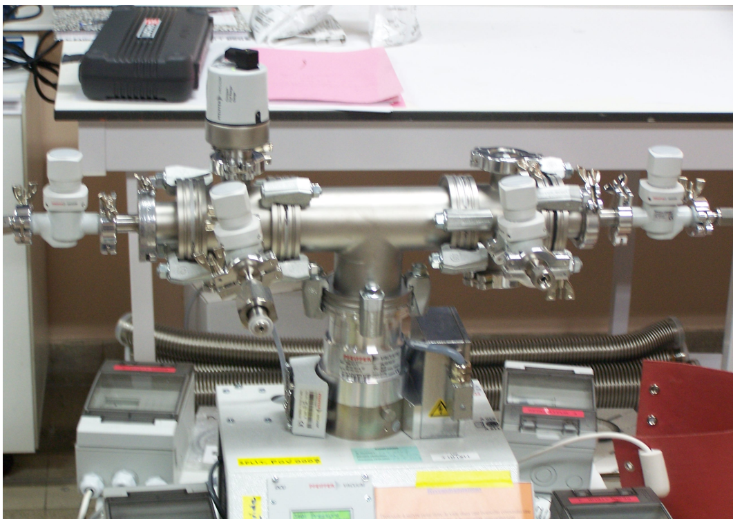
Figure 21 : Vue 3 du banc de mise sous vide des bouteilles
