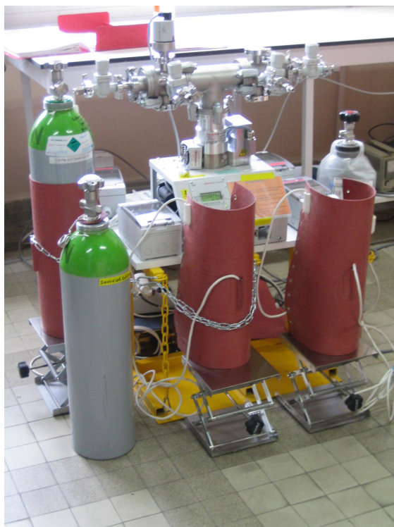
Figure 19 : Vue 1 du banc de mise sous vide des bouteilles
