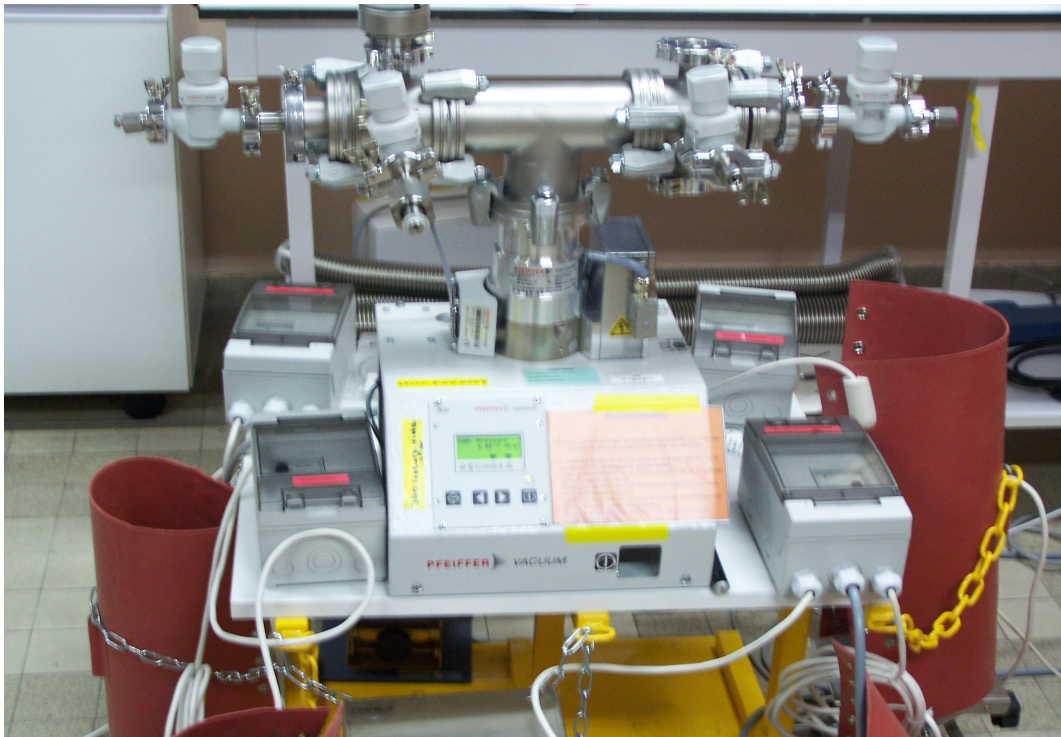
Figure 20 : Vue 2 du banc de mise sous vide des bouteilles
