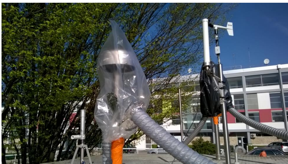
Figure 1 : Système de coiffage des têtes de prélèvement
