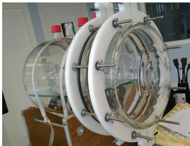
Figure 5 - Typologie de la chambre d'exposition de 36L en Pyrex
