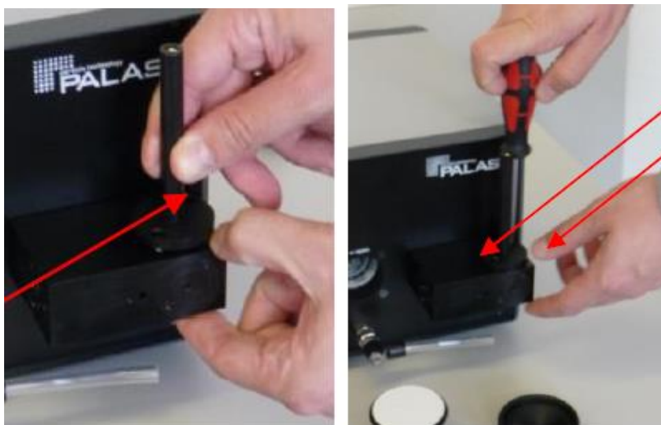
Figure 10 : retrait du tube d'entrée des aérosols dans la cellule de mesures et retrait des vis de la cellule de mesures
