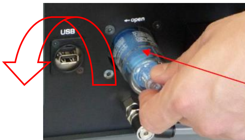
Figure 13 : retrait de la protection du filtre de pompe
