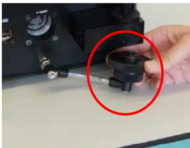
Figure 8 : porte-filtre en position ouverte sous la cellule de mesures
