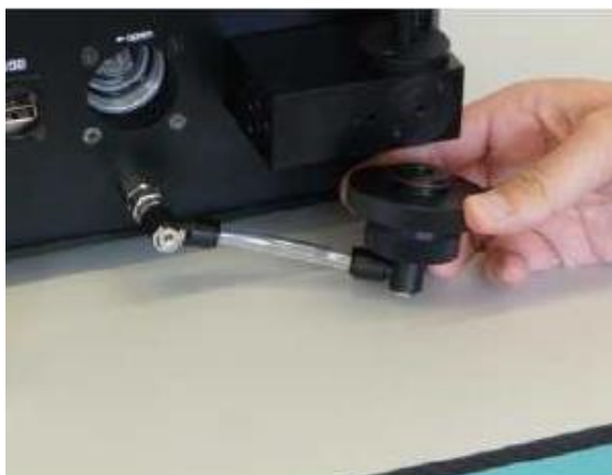
Figure 9 : retrait du porte-filtre sous la cellule de mesures
