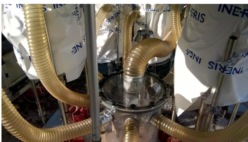
Figure 1 : AMS PM connectés au dispositif de dopage sur le toit de la station de « La faïencerie Creil, Atmo Haut-de-France ». Vue du système de distribution des particules.
