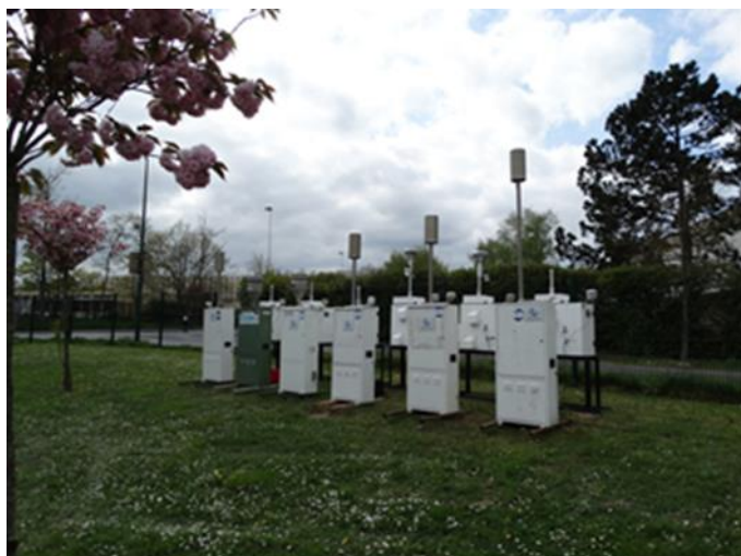
Figure 2 : Vue des dispositifs de prélèvement (6 Partisol + 6 DA80) déployés sur site
