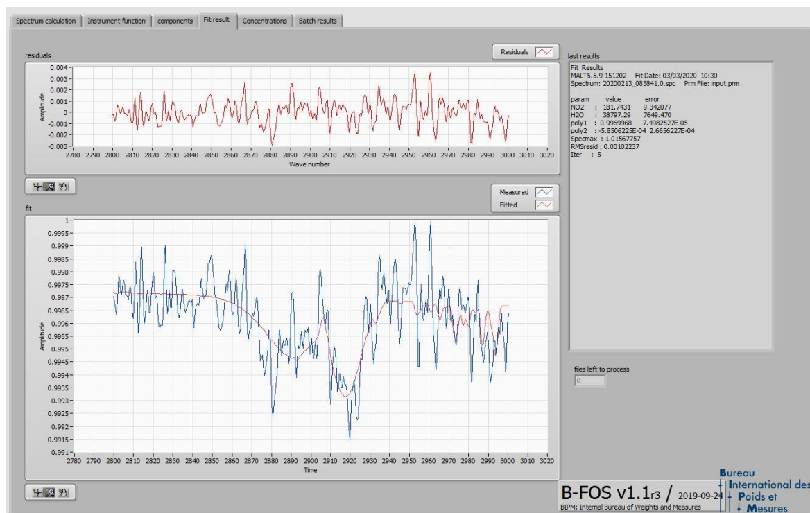
Figure 19 : Exemple d'ajustement du logiciel « Malt » pour la détermination de la fraction molaire en NO 2
