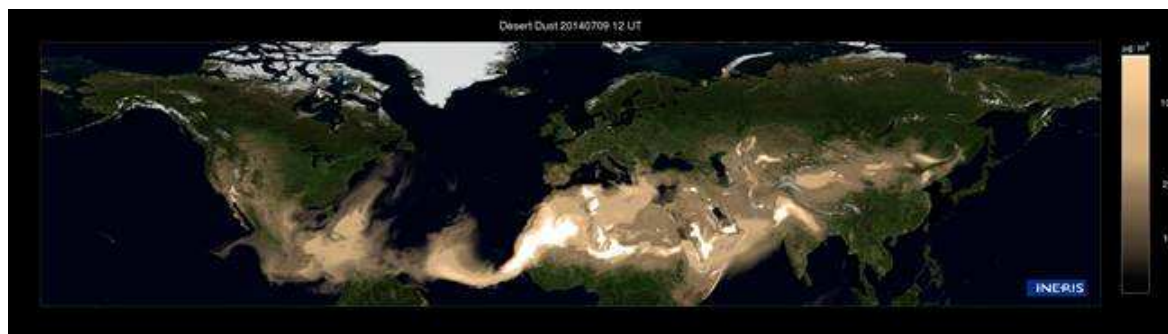
Figure 1 : Transport de poussières désertiques ( PM_{10} de surface, \mu g/m^3 ) le 9 Juillet 2014, simulation Ineris.
