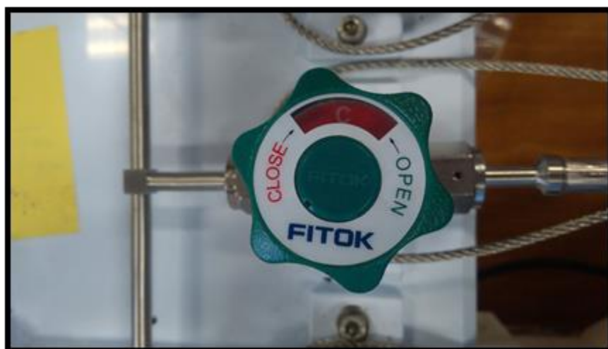
Figure 7 : Vanne en position fermée
