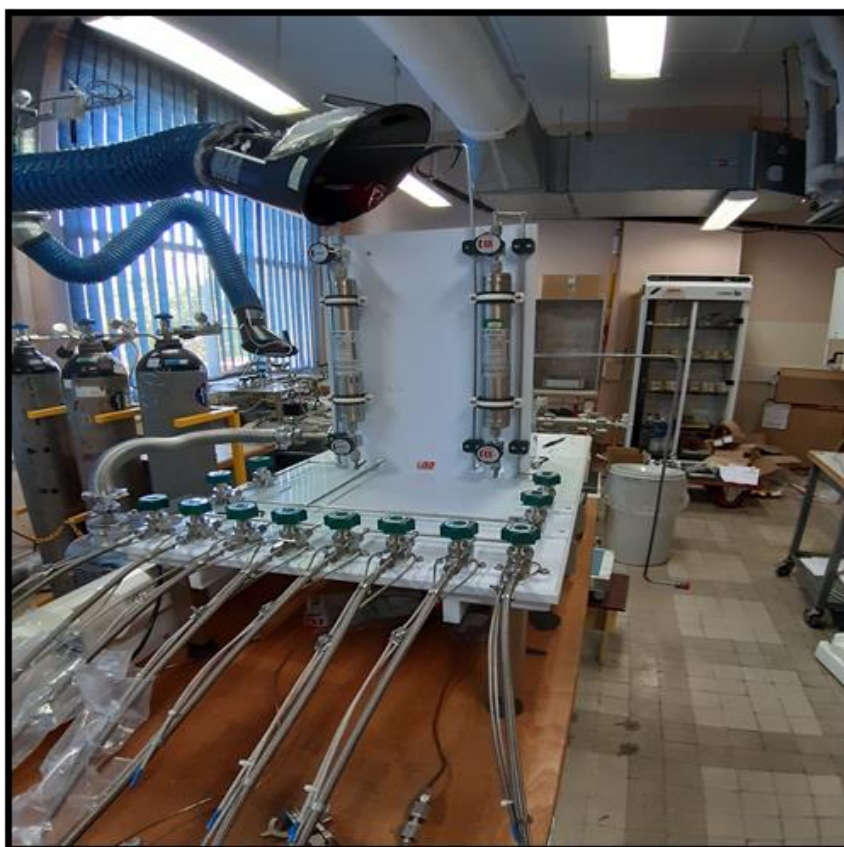
Figure 2 : Vannes d'arrivée des gaz
