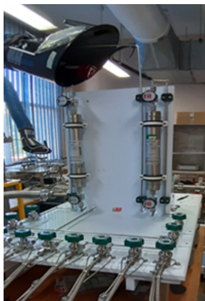
Rampe de fabrication de MRC (Matériaux de Référence Certifiés)
