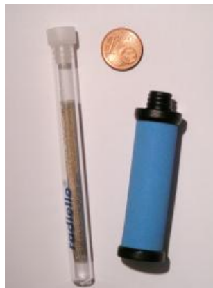
Figure 5 : Photographie d'une cartouche Radiello® code 165 (gauche) et du corps diffusif dans lequel elle doit être introduite pour le prélèvement (droite).
