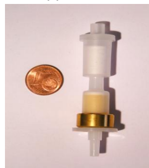
Figure 4 : Schéma d'un piège à ozone (gauche) et photographie d'un piège à ozone placé en amont des tubes de prélèvement actifs (Sep-Pack® et LpDNPH®)
