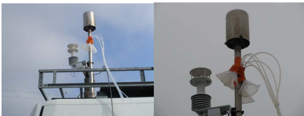
Figure 12 : Vue des lignes d'échantillonnage et des collecteurs d'air des analyseurs.
