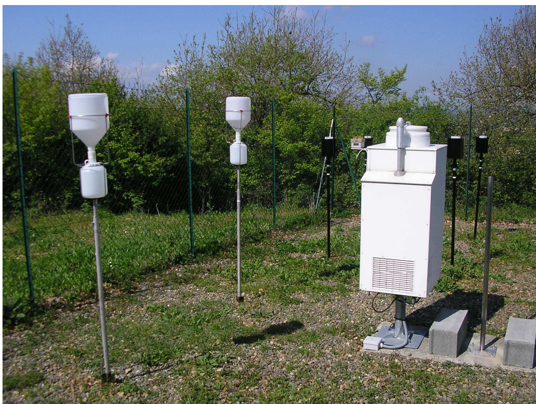
Figure 2 : Exemple de collecteurs (à Peyrusse-Vieille, France – Photo ORAMIP) de dépôt humide - Eigenbrodt et de dépôt totaux – jauge Nilu avec entonnoirs ou jauge Bergerhoff.
