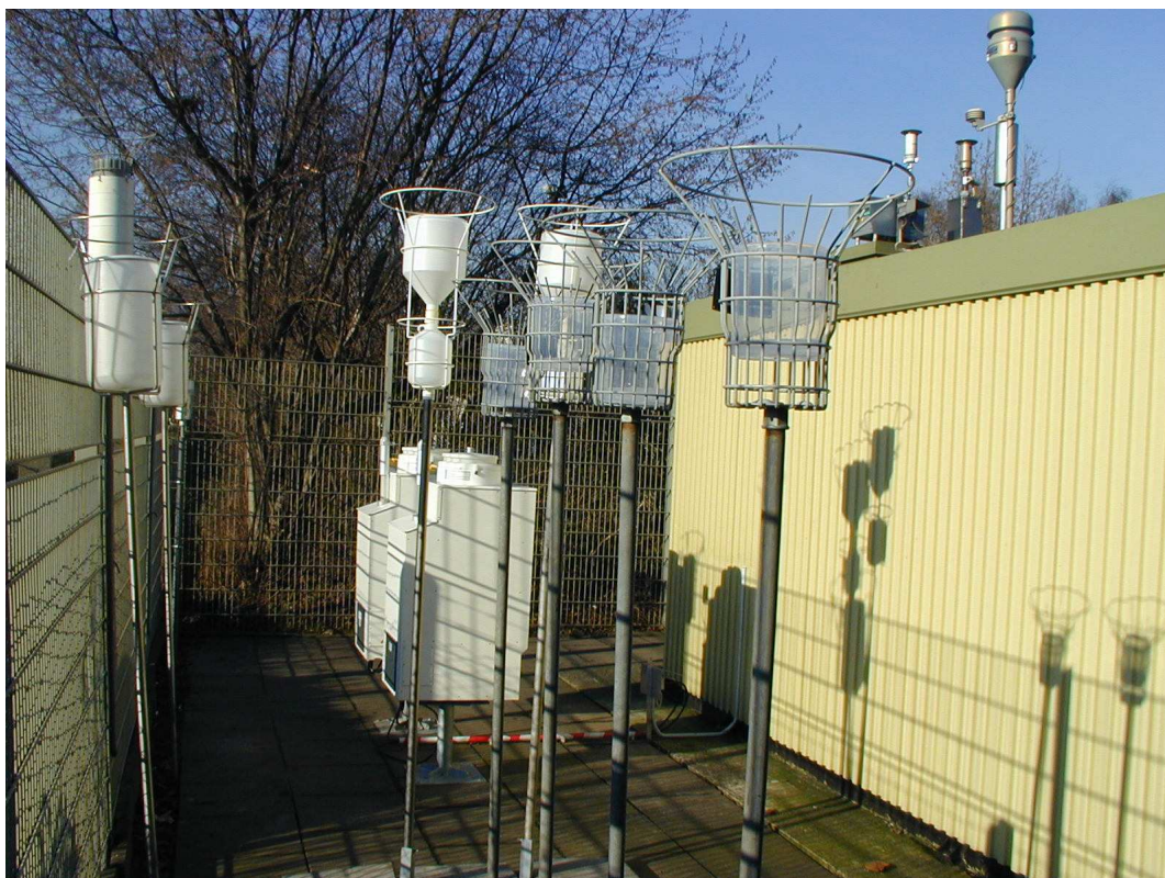
Figure 1 : Exemple de collecteurs (à Duisburg, Allemagne – photo D. Gladtkke) de dépôt humide - Eigenbrodt et de dépôt totaux – jauge Nilu avec entonnoirs ou jauge Bergerhoff.
