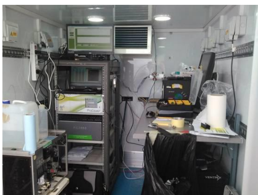
Photo 7. Intérieur de la remorque avec les 2 analyseurs LCSQA dans le rack
