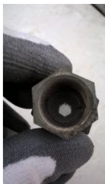
Photo 2. Vue du filtre métallique en entrée des lignes échantillon
