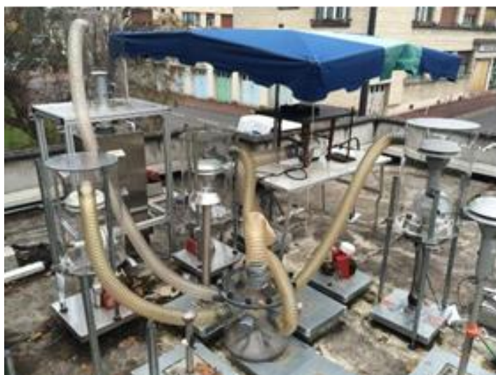
Photo 4. Vue du système de dopage des têtes de prélèvement sur la station de Creil
