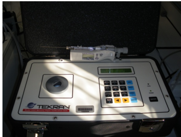
Figure 4 : Vue de la valise Tekran 2505 et de la micro seringue digitale Hamilton
