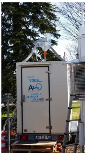
Figure 32 : Vue d'un moyen mobile alimenté en gaz au niveau des têtes de prélèvements
