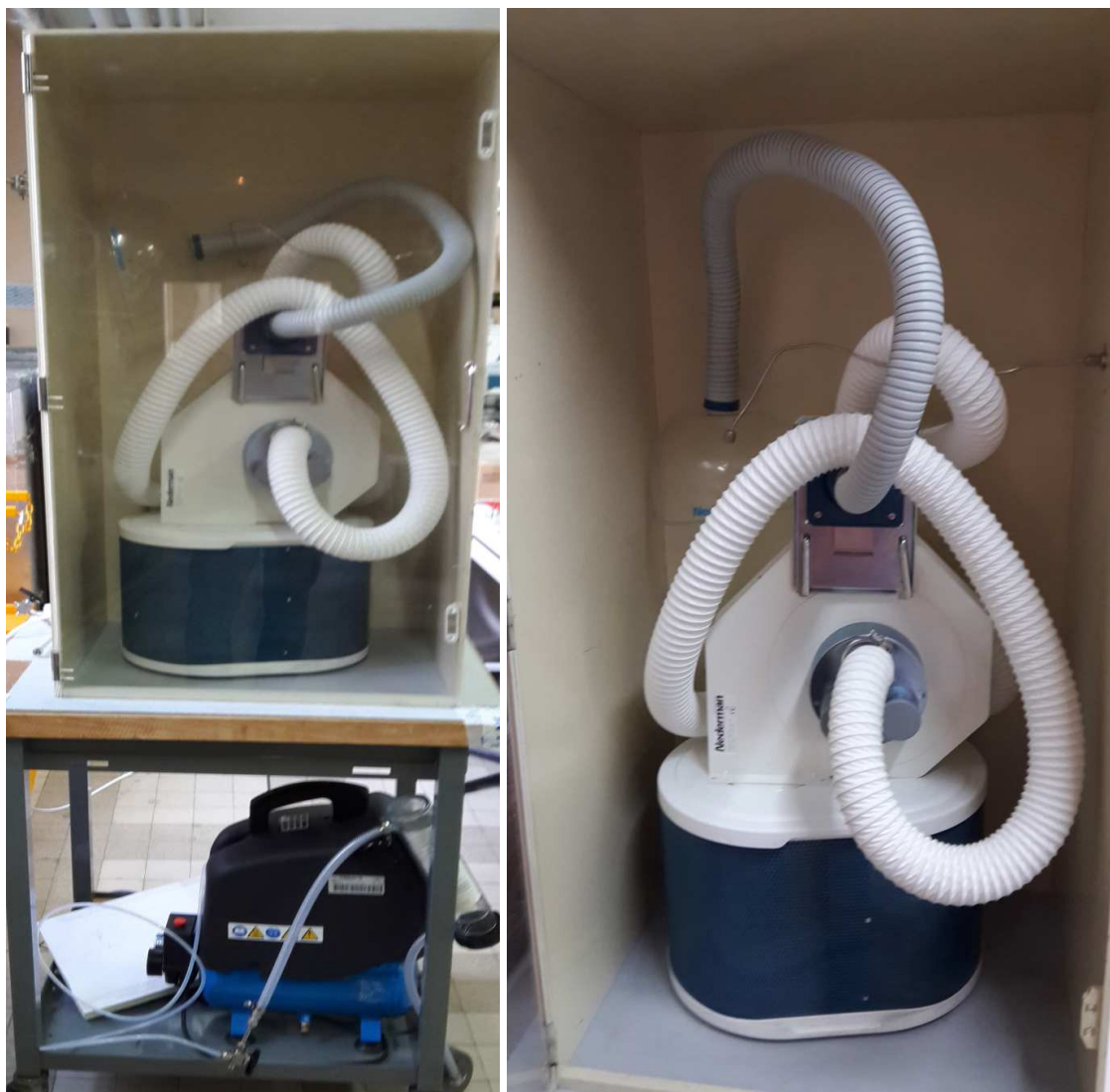
Figure 3 : Dispositif mis en situation de test dans la chambre de prélèvement a) Dispositif dans son ensemble avec la génération d'air de dilution épuré (à gauche) b) Dispositif dans la chambre de test (à droite)
