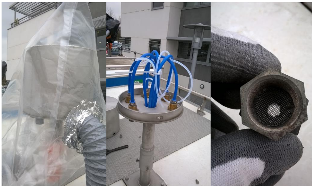
Figure 34 : Vues de la tête de prélèvement, des gaines fluidiques et du filtre d'entrée du laboratoire 2
