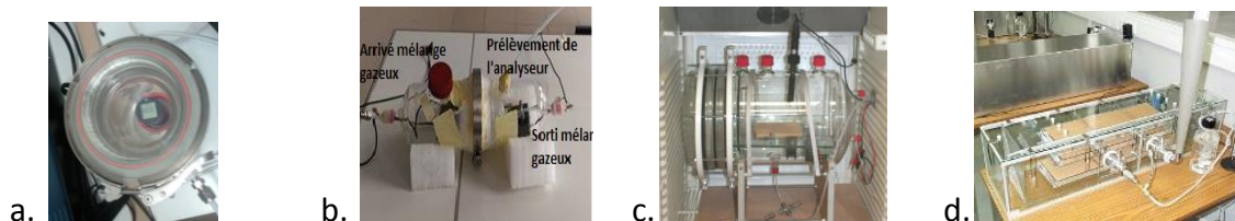
Figure 4- Les différentes typologies de chambres d'exposition testées durant le protocole : a- réacteur 1L, b- réacteur 6,5L, c- chambre d'exposition 36L, d- chambre Climpaq 51L
