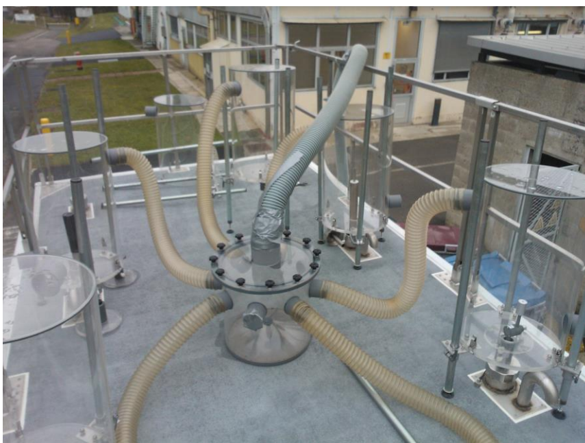
Figure 2 : Dispositif de distribution des particules installé sur le toit d'une remorque.
