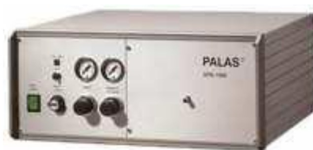
Figure 6 : Générateur à arc électrique, GFG 1000, PALAS
