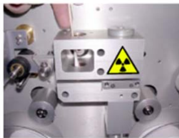
Nettoyage des traverses
