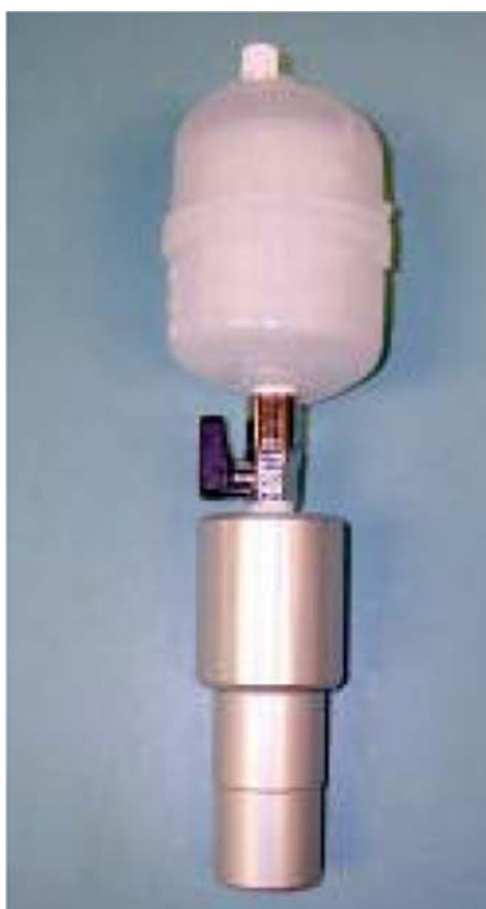
Figure A17.1 : Photographie du kit filtre zéro BX-302 utilisé pour les tests de zéro sur la BAM1020
