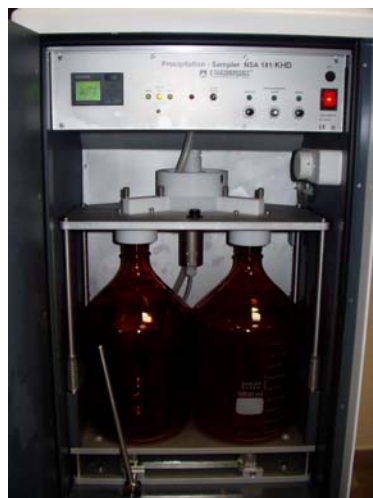
Collecteur de pluie wet-only Eigebrodt ; 2 semaines
