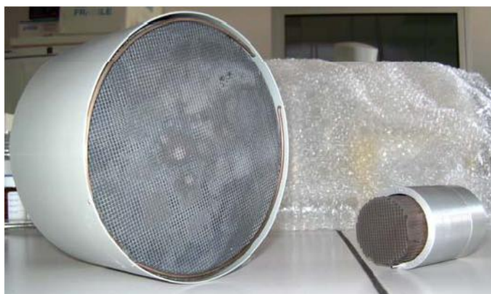
Figure 5 : Denuders MnO 2 utilisés pour le DA80 (gauche) et pour le Partisol à spéciation (droite)
