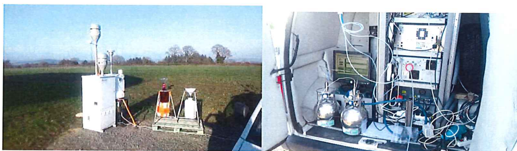
Figure 4: Photographies des instruments de mesure dans le camion laboratoire et des préleveurs extérieurs lors de la campagne d'évaluation du site candidat de Kergoff
